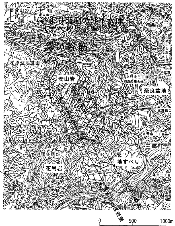
図-3 亀の瀬地すべり周辺の地形 2本の直線は図-2の断面位置 ハッチ(斜線)はキャップロック(安山岩)の範囲
