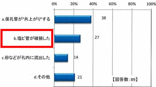
図-4 塩ビ製の保孔管の変更理由
