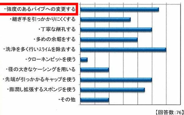
図-6 保孔管の設置で工夫したこと
