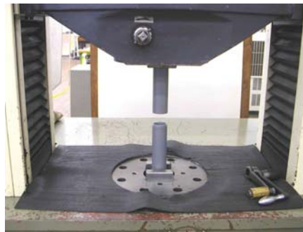
差込40A塩ビ管2.jpg 破断点試験力13.2kN
