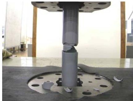
差込50A塩ビ管2.jpg 破断点試験力19.9kN
