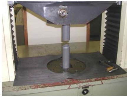
ネジ50A塩ビ管2.jpg 破断点試験力11.0kN
