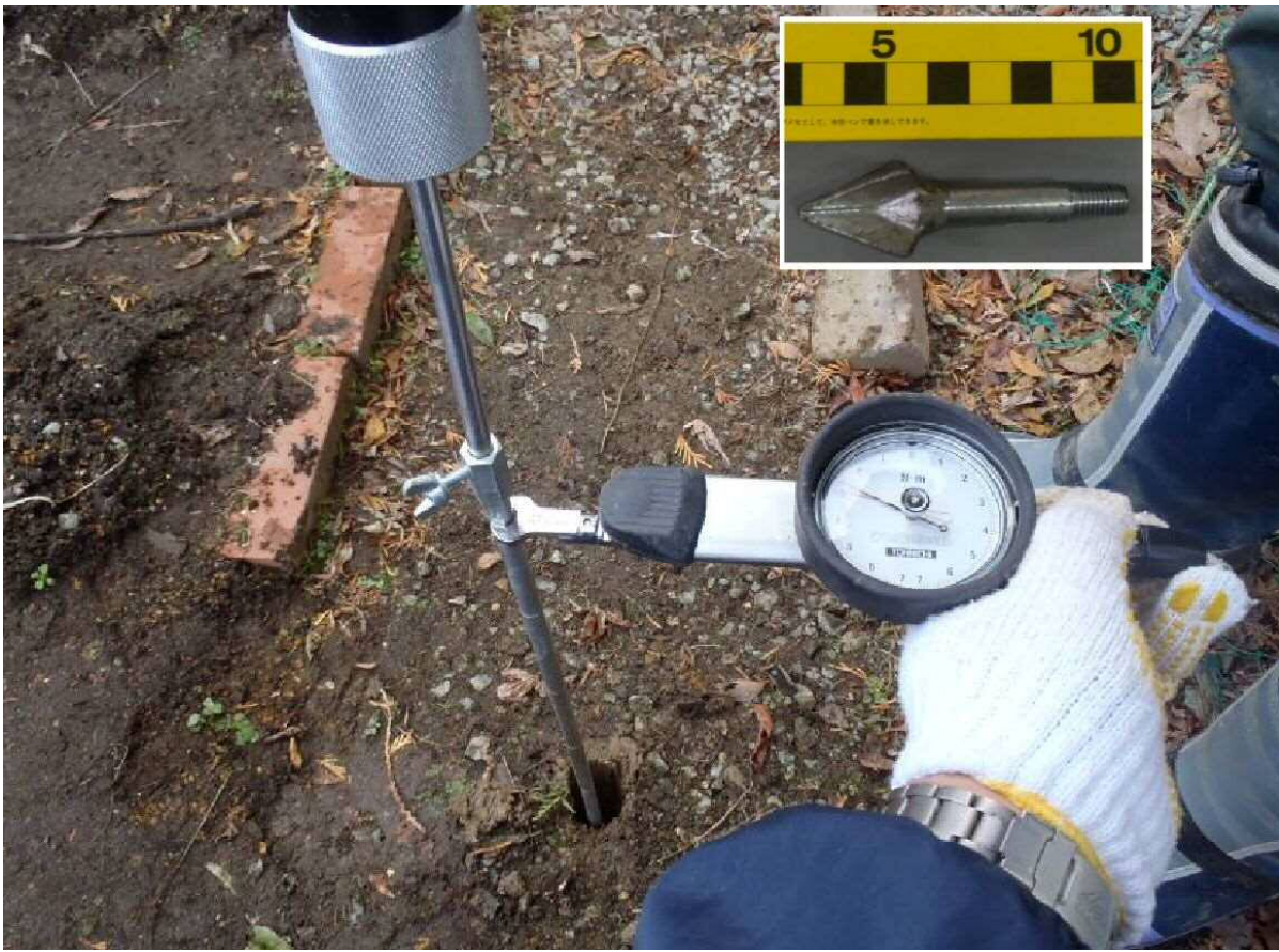
土層強度検査棒試験（ペーン試験）、粘着力 c 、内部摩擦角 \phi が計測できる
