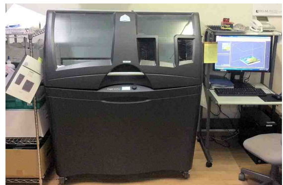
図2 フルカラー3Dプリンター (Projet 460 Plus ; 3D Systems 社製)
