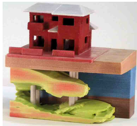
図4 家と地盤と地盤改良模型例
