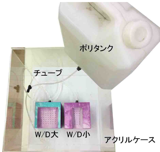
図5 W/D比を変えた谷埋め盛土用模型
