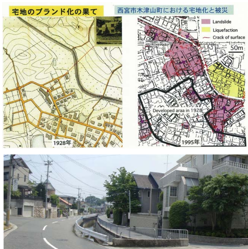
戦前の分譲宅地のチラシと、現在の市街地図と被災箇所（釜井先生資料） 現在の宅地の状況（復旧後；撮影太田）
